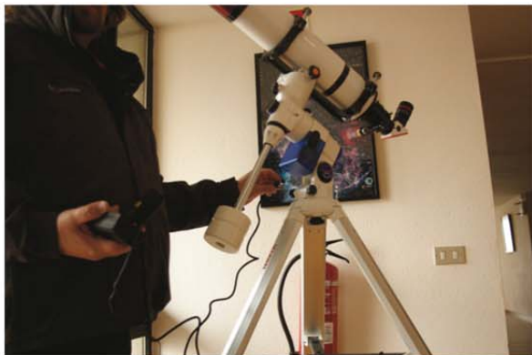
10. Enchufe el mando al motor de ascensión recta.
