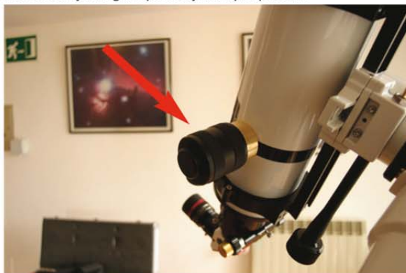
17. Aunque en principio no es necesario, puede sintonizar el filtro H-alpha con esta rosca.
