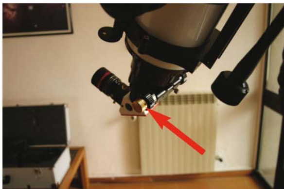
16. Puede enfocar utilizando esta rosca.
