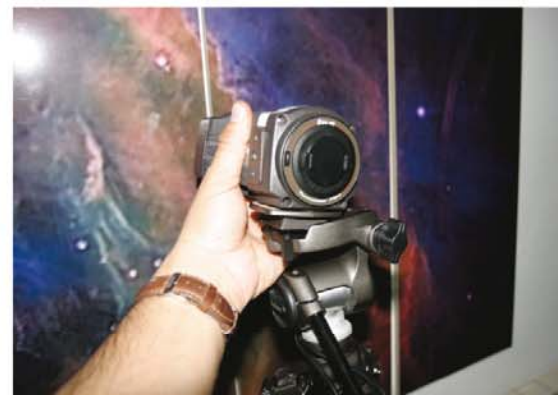
3. Extraiga la cámara y con mucho cuidado póngala en el trípode. Para ello es necesario inclinarla para que encaje en la base..
