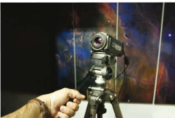
7. Retire la tapa de la cámara (tenga cuidado, se puede perder) y oriente la cámara según convenga. Puede fijarla en una posición.
