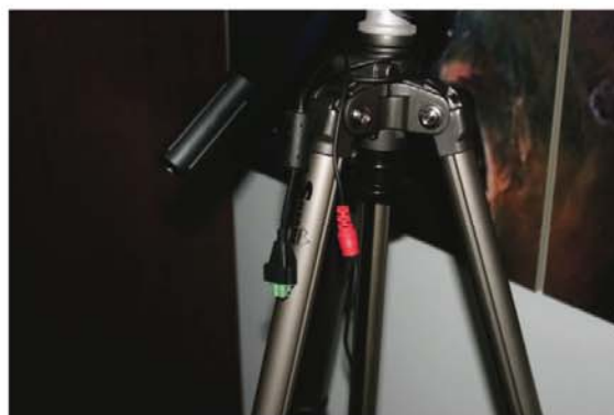
5. Hay dos cables junto al trípode, uno verde (corriente) y otro rojo (señal de video).
