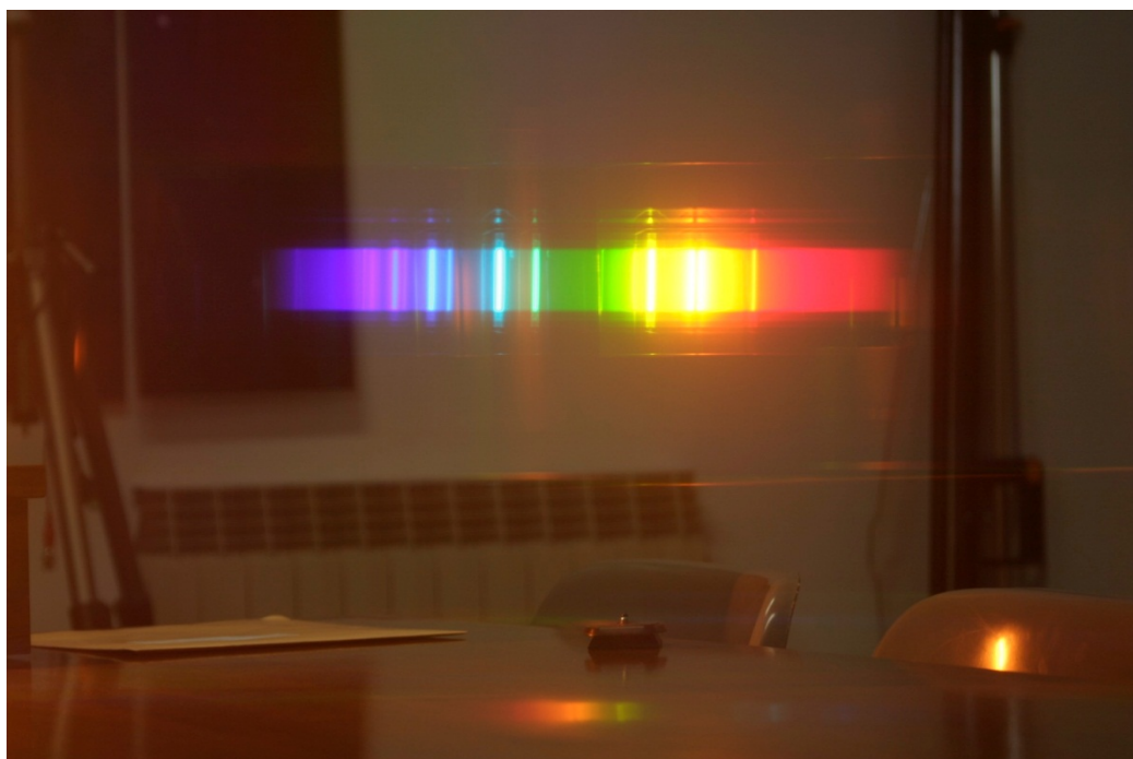
Espectro de la lámpara de sodio a alta presión visto a través del grisma.
