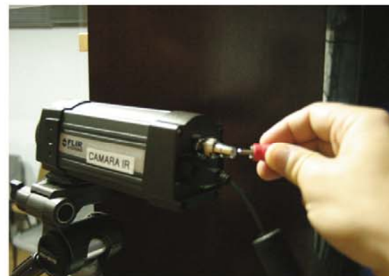
6. Conecte ambos cables a la parte trasera de la cámara..
