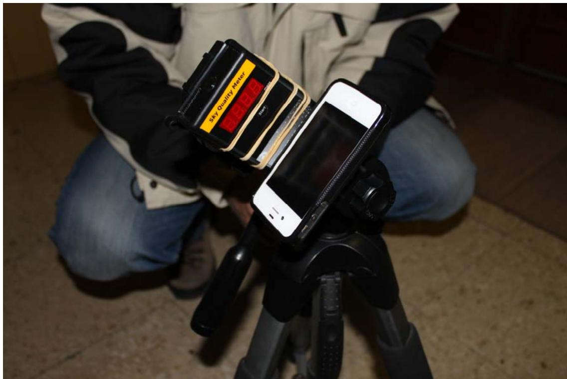
*Fotómetro SMQ-L montado sobre un trípode junto con un iPhone que posee brújula digital. La brújula permite la calibración en azimut. La altura sobre el horizonte puede determinarse con una plomada y un círculo previamente graduado.*
